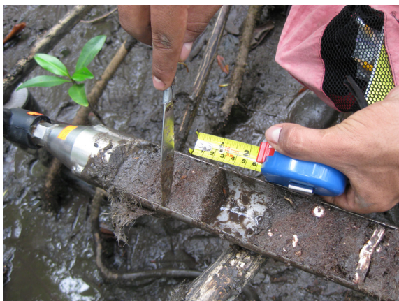
Figura 16. Extracción en campo de un volumen conocido de suelo de manglar (izquierda) para el análisis posterior de densidad aparente en el laboratorio. Fotografías: Miguel Cifuentes.
