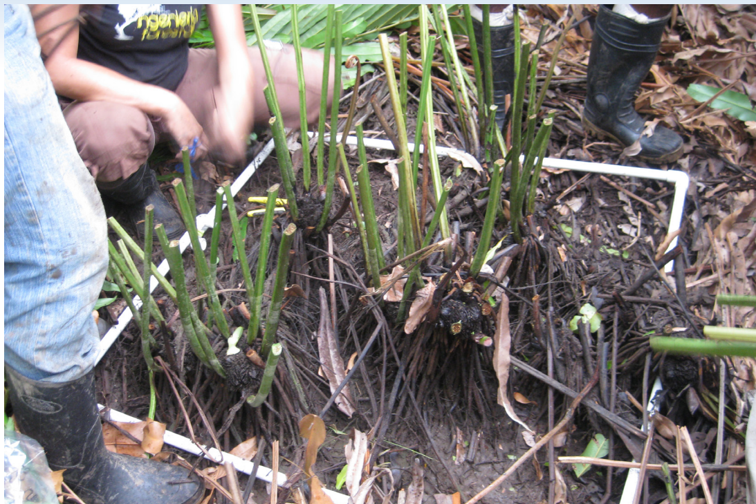
Figura 12. Para cuantificar la biomasa del material herbáceo se utilizan marcos de medición contruidos de material resistente (por ejemplo, PVC) de 1 x 1 m para delimitar el área dentro de la cual se cosecha por completo el material vegetal para determinar su peso fresco total. Fotografía: Miguel Cifuentes.
