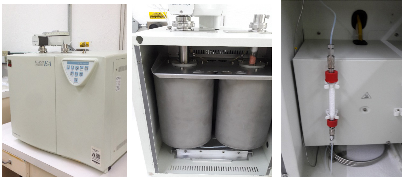
Figura 24. Aparato autoanalizador de carbono y nitrógeno total marca ThermoFinnigan, modelo Flash EA 1112 Series 16 , instalado en el laboratorio analítico de CATIE, en Costa Rica (izquierda). Detalle de los componentes internos del autoanalizador: estufa y columnas reactoras (centro) y desecante y detector de conductividad térmica o cromatográfica (derecha). Fotografías: Miguel Cifuentes y Patricia Leandro.
