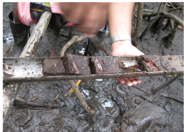
Figura 16. Extracción en campo de un volumen conocido de suelo de manglar (izquierda) para el análisis posterior de densidad aparente en el laboratorio. Fotografías: Miguel Cifuentes.
