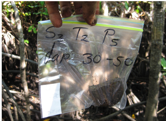
Figura 17. Almacenamiento y rotulación correctos en el campo de una muestra de suelo de manglar destinada para el análisis de densidad aparente (“dap”). Los códigos corresponden al número de sitio (S), transecto (T) parcela (P), tipo de muestra y el intervalo de profundidad del perfil de suelo al que corresponde (30-50 cm). Nótese la etiqueta de respaldo, escrita con tinta indeleble sobre papel impermeable que se incluye en caso de que la rotulación original se pierda. Fotografía: Miguel Cifuentes.
