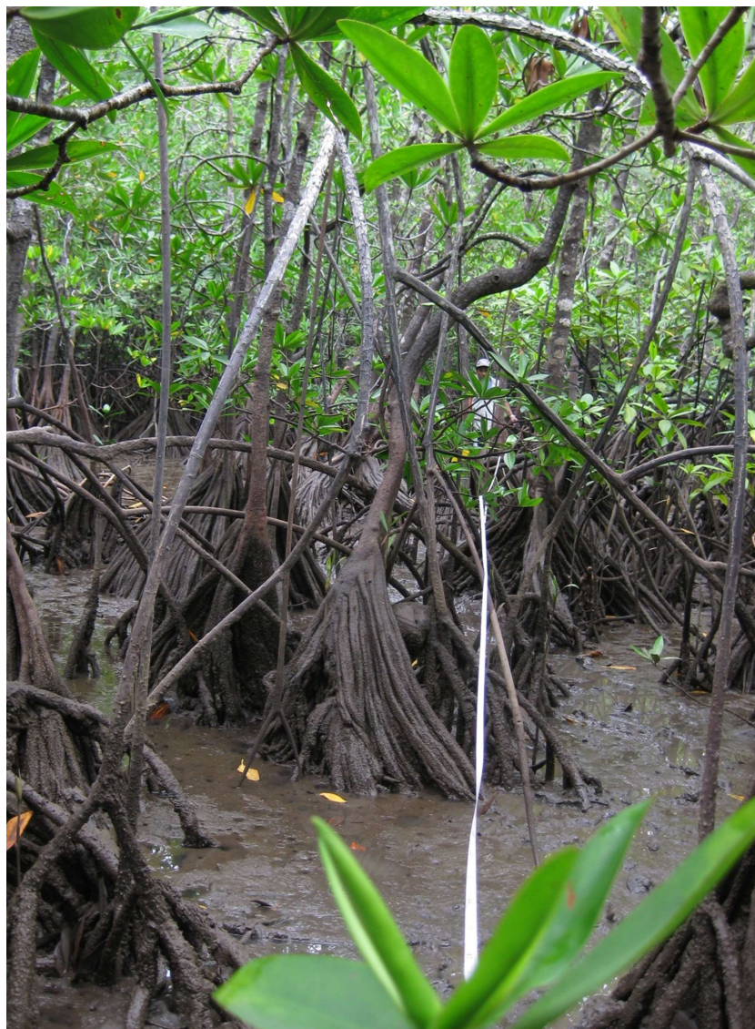
Figura 7. Demostración del establecimiento de un transecto para la medición de carbono en manglares con una cinta métrica para mantener la dirección del transecto y ubicar las parcelas de medición cada 25 m. Fotografía: Miguel Cifuentes.
